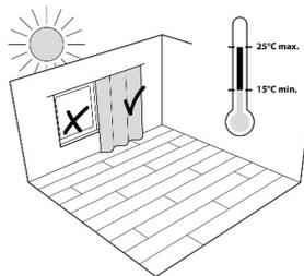
L'humidité ambiante et la température du support doivent être telles qu'il n'y ait pas de condensation au niveau du support (point de rosée). La température du support doit être supérieure de 3°C au point de rosée.
