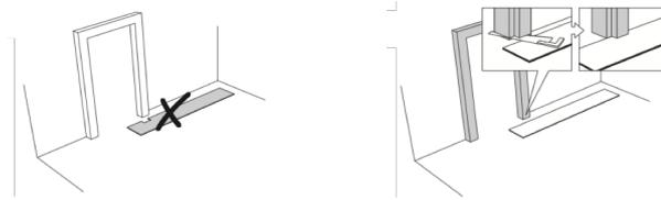
Lorsque cela n'est pas réalisable, le revêtement sera découpé et le jeu périphérique de 5 mm sera protégé avec des caches adaptés (type STOSETT) ou calfaté avec le mastic OTTOSEAL S51 (en ayant préalablement mis le fond de joint OTTOCORD PE-B2) afin de parfaire la finition.
