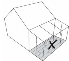
En cas d'exposition à l'ensoleillement (présence de baie vitrée, de fenêtre de toit ou de puits de lumière), prévoir une protection par occultation (film anti-chaueur, volet, rideau, store, ...) pour éviter une décoloration et une dilatation importante du produit. La température au sol devra être comprise entre 12°C et 32°C.
