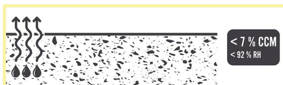
Le taux d'humidité ne doit pas excéder 7 % au test de la bombe à carbure (Control Carbide Moisture).
