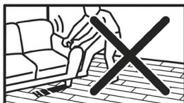
La mise en service est immédiate après l'installation. Prendre des précautions avec l'utilisation de mobiliers lourds. Proscrire les embouts caoutchouc (risques de taches noires).
