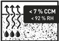
Le taux d'humidité ne doit pas excéder 7 % au test de la bombe à carbure (Control Carbide Moisture) et 0,5 % CCM sur chape anhydrite.
